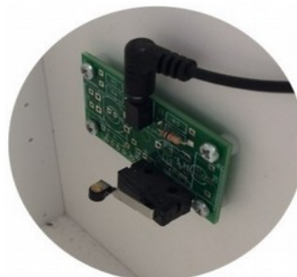
Le micro-rupteur à galet est contacté quand la porte s'ouvre et « appuie sur le galet »
