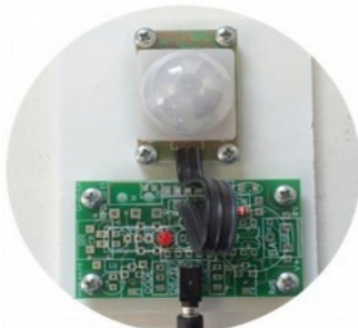
Capteur infrarouge : détection des personnes
